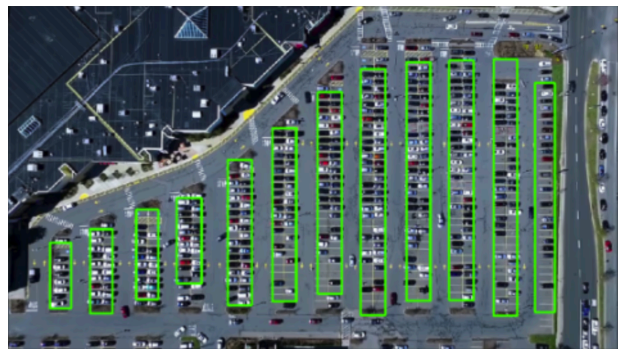
(Obrázok 6) vyznačenie parkovacích blokov pomocou zhlu- kovania x-ových súradníc
